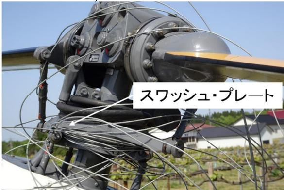
図5 スワッシュ・プレートの鋼線の巻き付き
